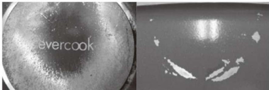
④外面塗装のはがれ
