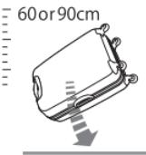
角は 60cm、面と辺は 90cm の 高さから落下させ、ボディや各 部の耐衝撃性をテストします。
